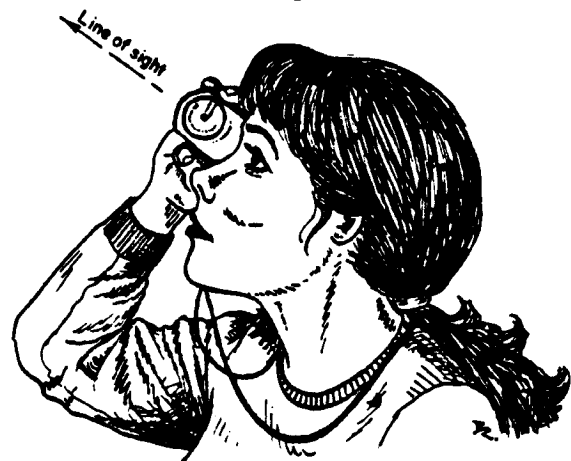
Figure 6-7. Use of the Suunto clinometer.
